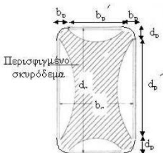
Σχήμα 6.9.: Περίσφιγξη με ινοπλισμένα πολυμερή – στρογγύλευση γωνιών.
